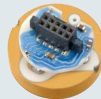
Die Druckaufnehmer finden aufgrund der kleinen Baugröße in der Medizin- und Labortechnik sowie der hydrostatischen Füllstandmessung breite Einsatzmöglichkeiten. Das Sensorelement hat einen Durchmesser von 17,5 mm und wird im Gehäuse individuell über Druck und Temperatur kompensiert.
